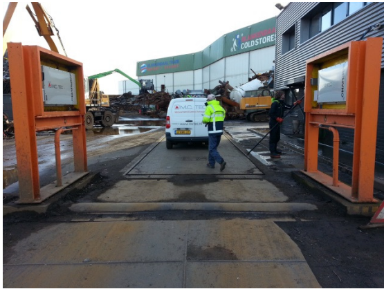
Portal Detector at Koster Metalen in Beverwijk
