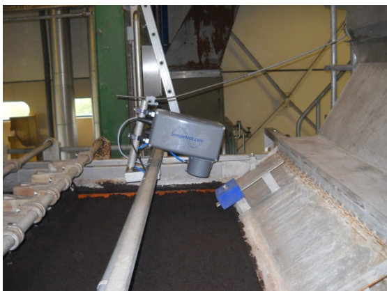
On-line NIR vochtmeter voor het meten van vocht in slib van afvalwater
